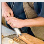
Ударная стамеска, короткая, легкая, согласно В DIN 5139 с боковыми фасками, с восьмигранной рукояткой из граба и ударной головкой
